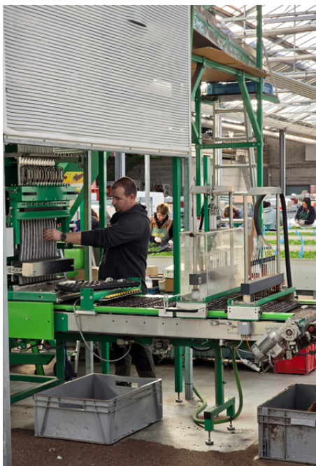
Da Psenner, la macchina che dispone il cilindro di rete con la talea a radicare; sullo sfondo: operaie che invasettano le talee
