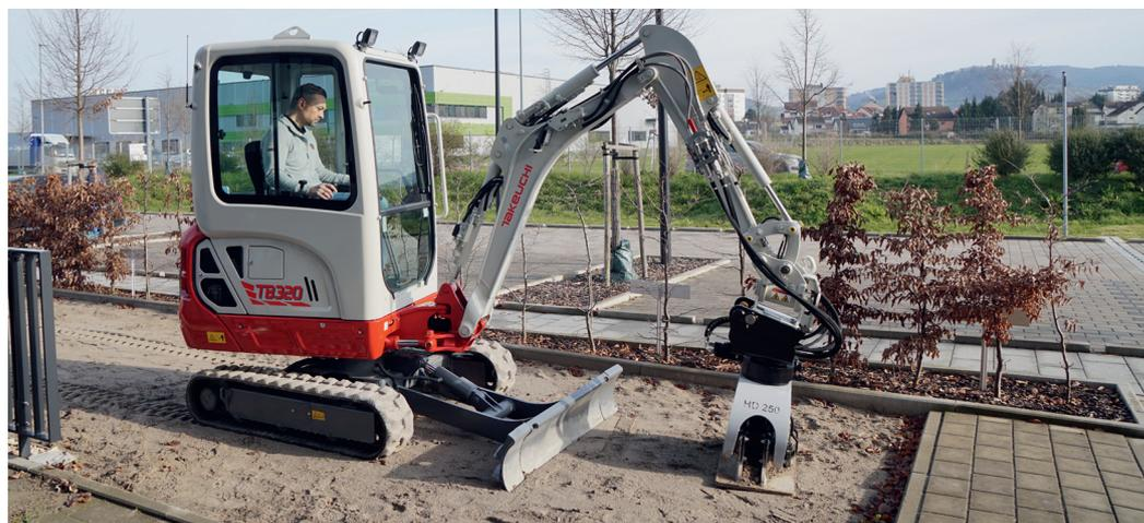
Hydraulikhammer, Sortiergreifer, Verdichterplatte und andere Anbaugerät können mit dem Takeuchi TB 320, dem neuesten Kompaktbagger von Takeuchi, genutzt werden.
